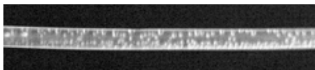
写真1. 輸液ライン中の気泡（1時間室温放置）
